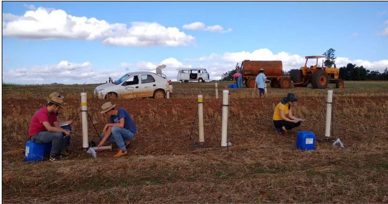
Teste de infiltração no solo e na base dos terraços (UFSM)
